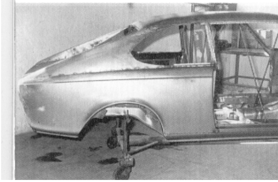
La cantidad de estaño utilizado en la construcción fue uno de los grandes inconvenientes.
