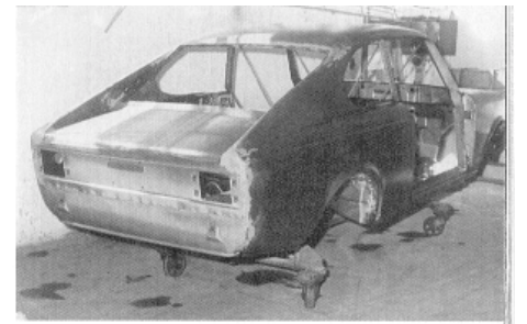
Otra prueba que nunca se hizo realidad, la cola "fast back" con nervaduras laterales hacia atrás.
